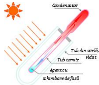
b) Tub termic simplu. Mod de funcționare
