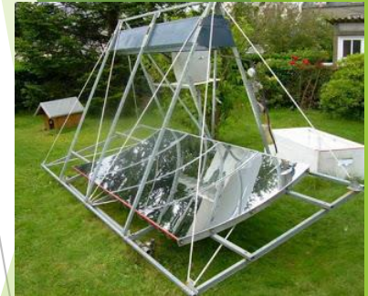
i) Colector solar cu lentile Fresnel pentru sterilizarea instrum. med.
