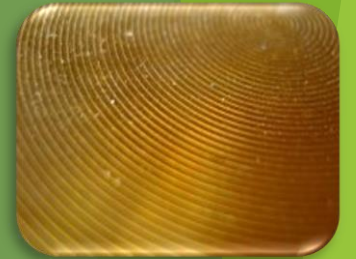
f) O folie de plastic plat, subțire, transparent și flexibil, cu cercuri concentrice pe ea se comportă ca o lentilă Fresnel.
