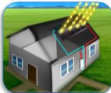
e. Mod de integrare în instalația domestică
