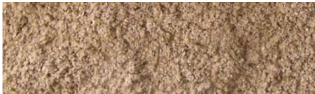
Figura 3.70 Izolație din celuloză
