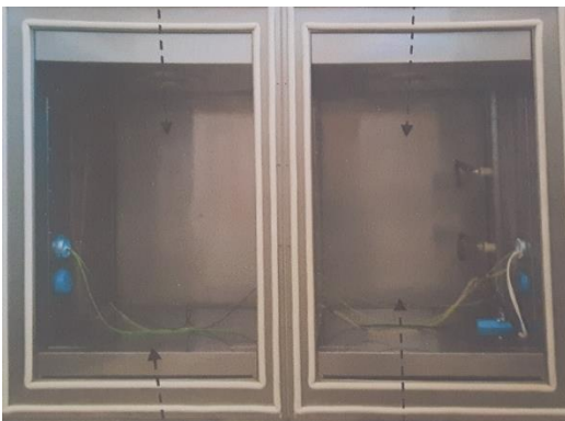
Figura 5.9 Standul experimental utilizat pentru studierea materialelor cu schimbare de fază
