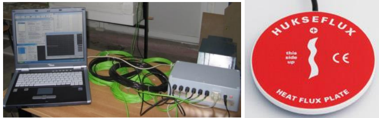
Figura 5.4 Fluxmetru. Senzor de flux
