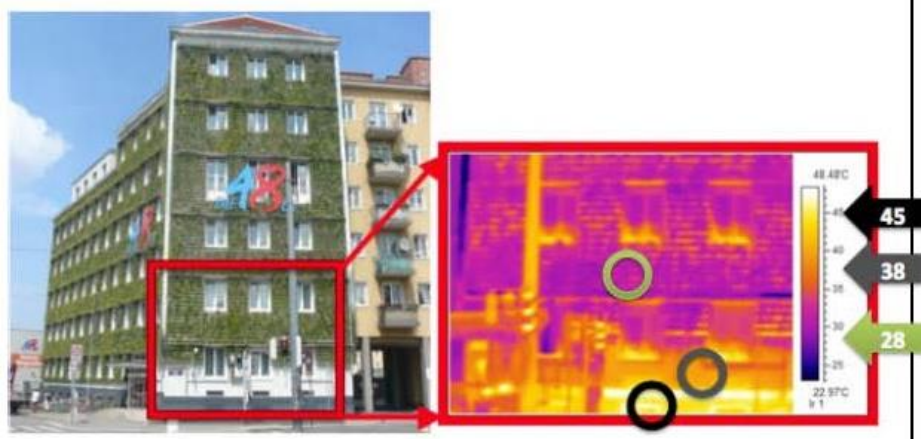
Figura 3.45. Termografie indicând temperaturi mult mai reduse la nivelul fațadei verzi decât în zonele fără vegetație ( http://www.biotope-city.net/article/resilience-cityscapes )
