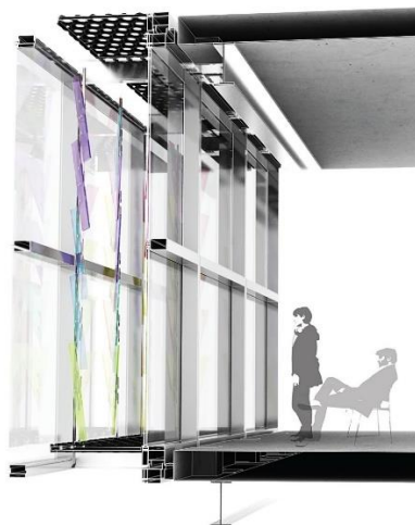
Figura 3.48 Schematizare a sistemului double-skin
