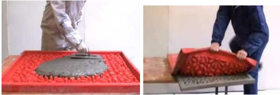
Fig. 2.2 Realizarea betonului armat cu fibre de sticlă prin procesul de preamestecare și turnare.
