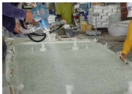
Fig. 2.1 Realizarea betonului armat cu fibre de sticlă prin procesul de pulverizare.
